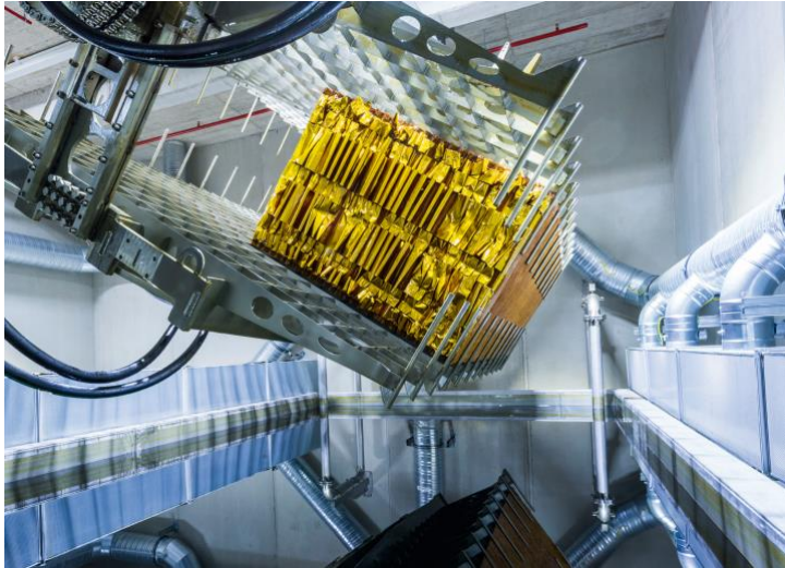
Bildtext: Die Anlagen können Wabenblöcke hoch automatisiert fertigen. Foto: Schütz
